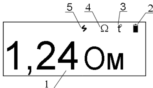
Рисунок 1.4.5 – Вид индикатора в режиме «Омметр».
